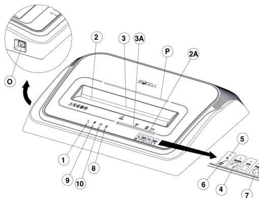
1. FORWARD - chod řezných nožů dopředu. Pokud držíte tlačítko stisknutí po dobu 7 sekund, zapne se 30-ti sekundový režim skartace. Používá se při skartaci průhledných dokumentů, na které elektronické čidlo nereaguje.
